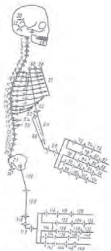
Рис. 17.42. Структурная схема опорно-двигательного аппарата человека (по А. Morecki et al., 1981)
